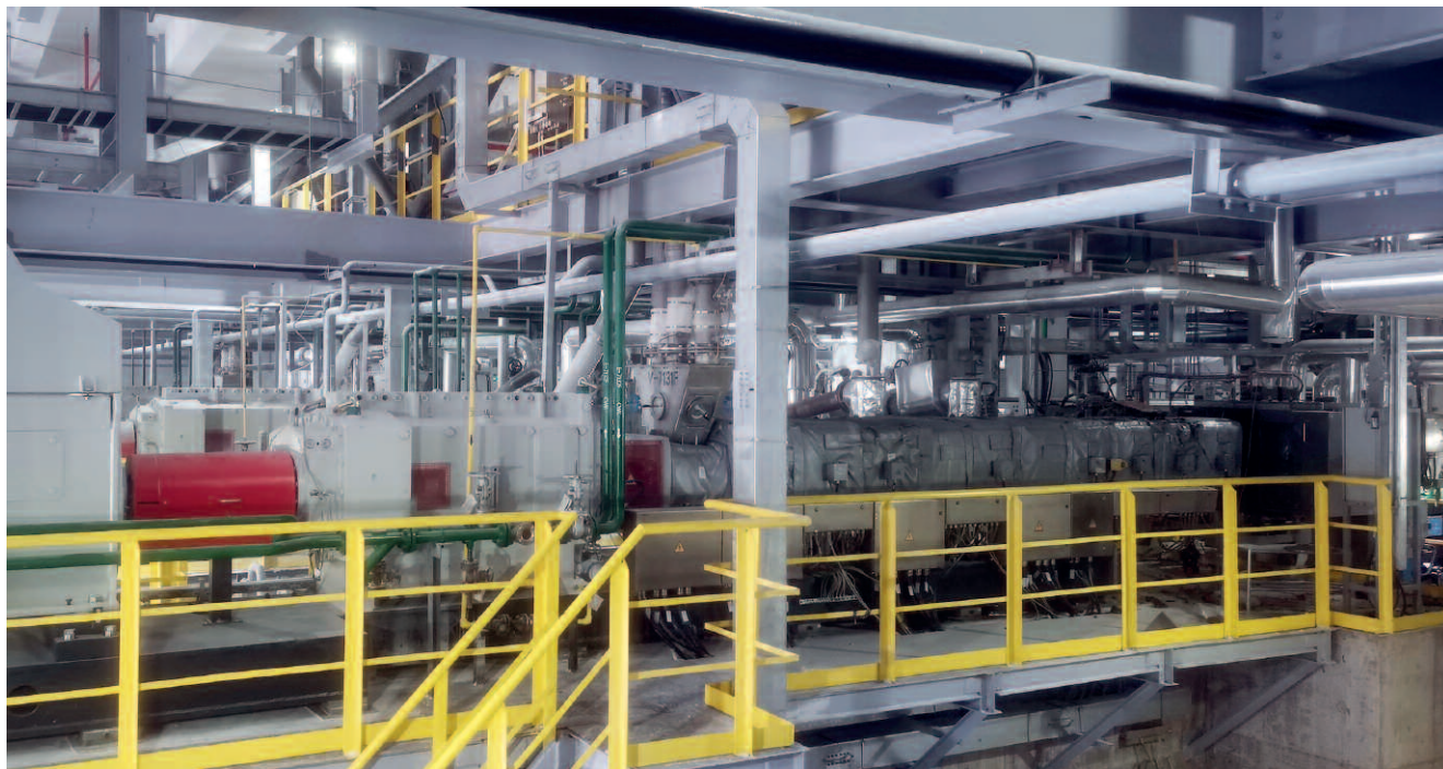
科倍隆的ZSK Mc18双螺杆挤出机在该系统中发挥着关键的核心作用，可以特别节能地制造ABS共混物 (图片:浙江智英石化科技有限公司)
